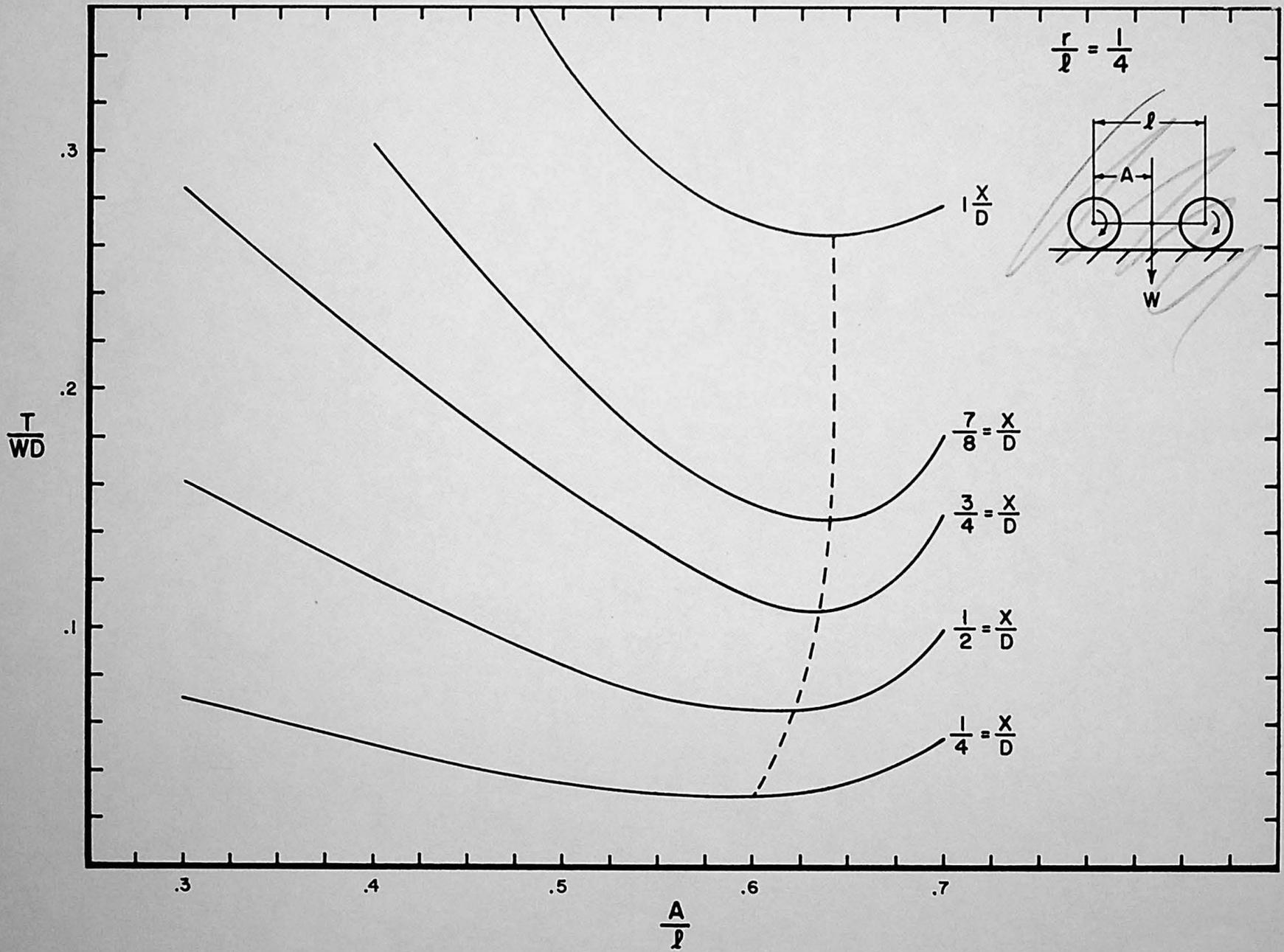
VEHICLE C.G. LOCATION FOR MINIMUM TORQUE & MAXIMUM OBSTACLE NEGOTIABILITY
