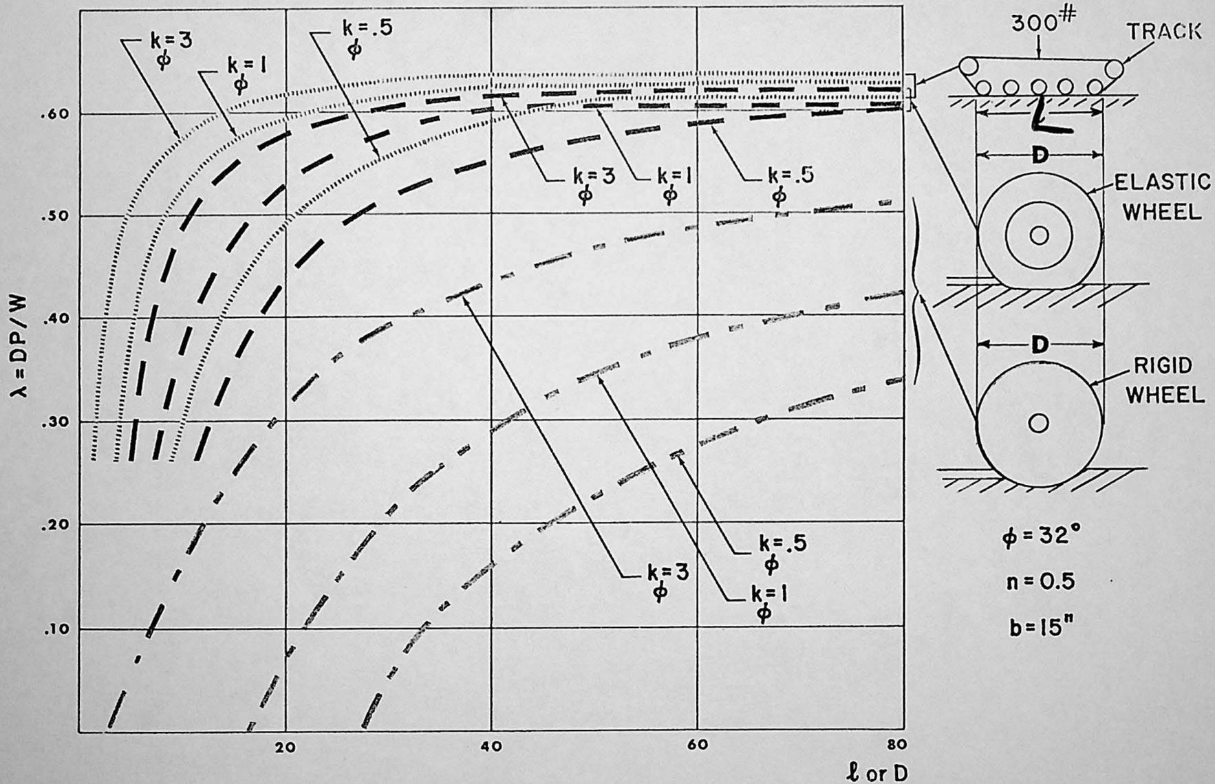
DRAWBAR PULL WEIGHT RATIO OF COMPARABLE TRACK
